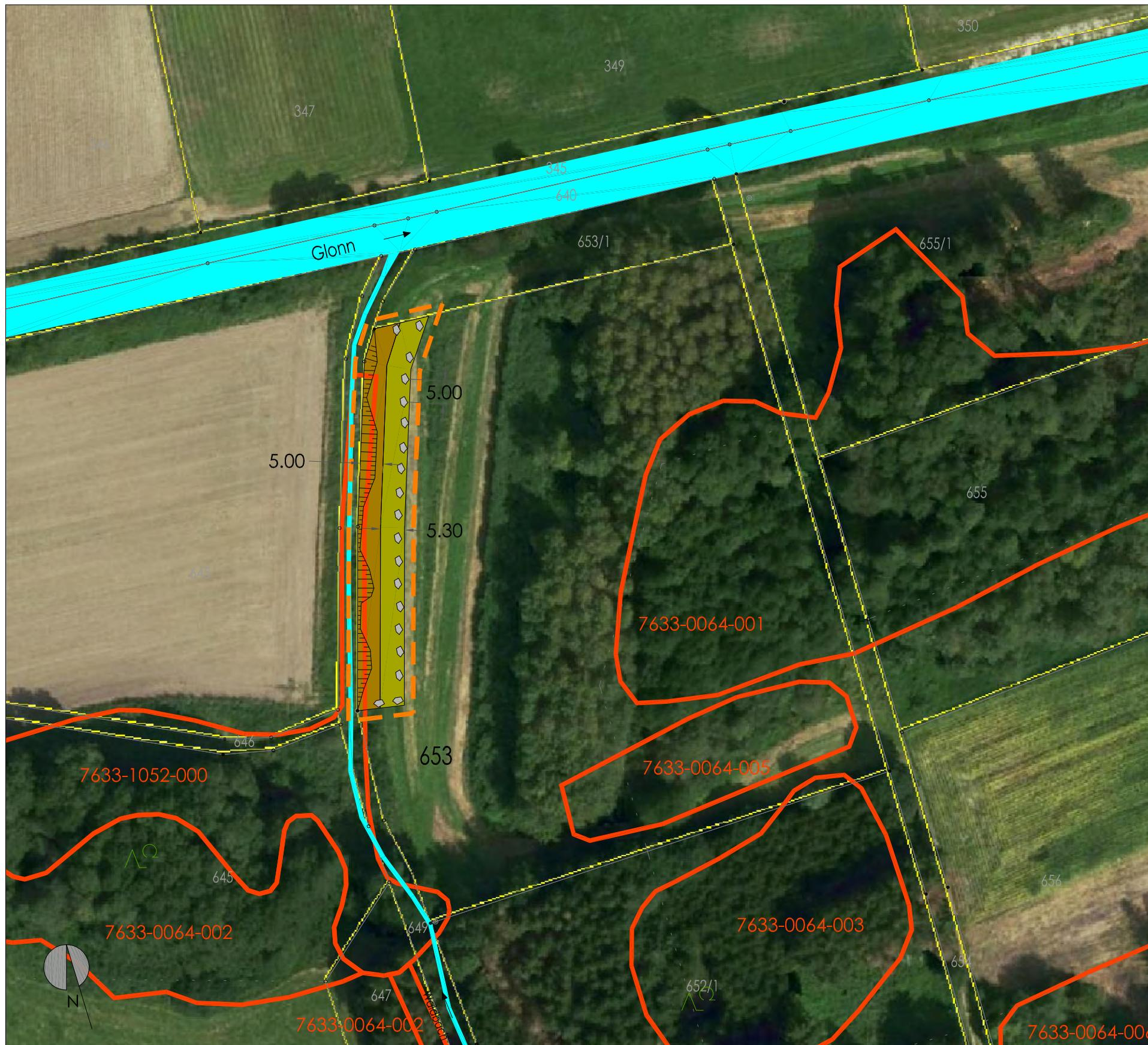
buchtige Abflachung Ufer: Ausführung nur oberhalb Mittelwasserlinie. Anfallender Aushub kann im Gelände einplaniert werden.
